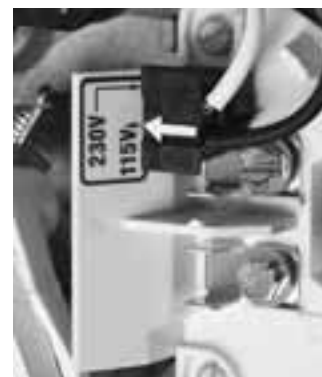
Figura 4B - Ficha de cambio de tensión configurada para 115 V.
