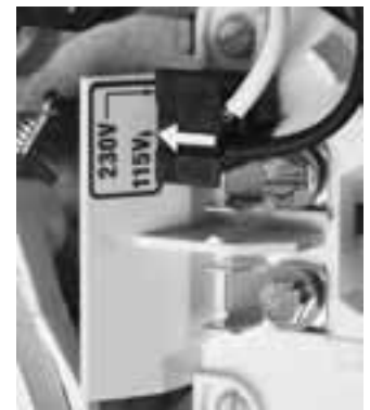
Figure 4B - Prise de modification de la tension réglée sur le 115 V
