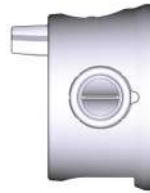
Adapter with Check Valves in Bag #1, position for 3 port control valves. Adaptador con válvulas de retención, posición para válvulas de control de 3 puertos. Adaptateur avec clapets de non-retour; position pour les soupapes de contrôle à 3 orifices.
