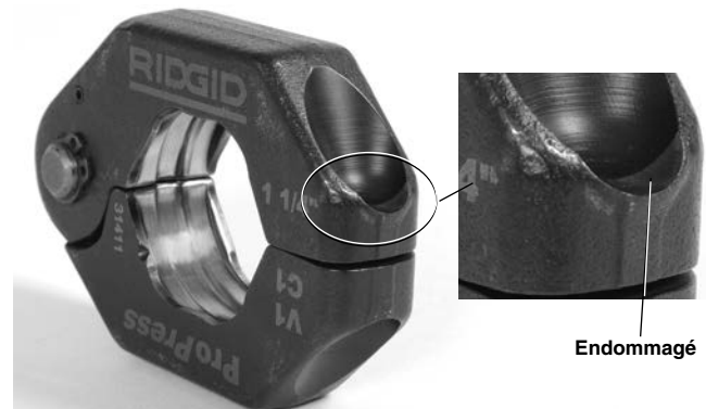
Figure 13 – Logement de bague endommagé
