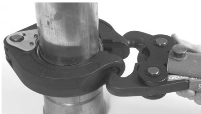
Figura 14A – Las puntas del accionador V2 asentadas en las cavidades del aro XL-C
