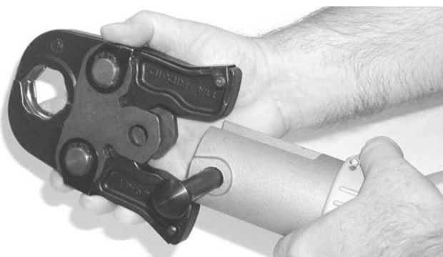
Figura 5 – Jale el pasador para el montaje del accesorio
