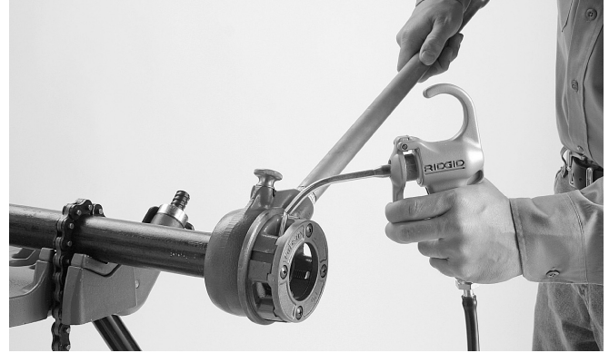
Figure 4 – Application de l'huile de coupe
