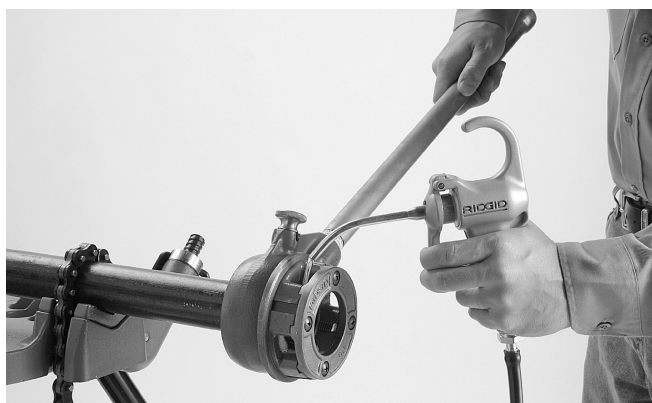
Figura 4 – Aceitado con aceite para cortar roscas
