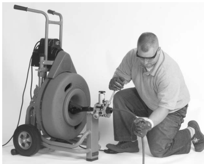
Figure 10 – Position de travail appropriée
