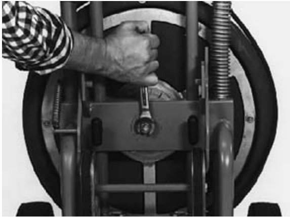
Figure 7 – Vérifiez le serrage du boulon
