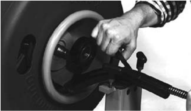
Figure 22 – Retrait du guide-câble
