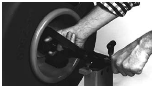
Figure 21 – Retrait de la manette de l'arbre central
