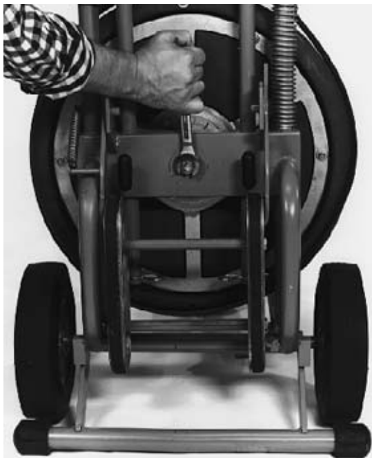
Figure 19 – Retrait du boulon du support arrière
