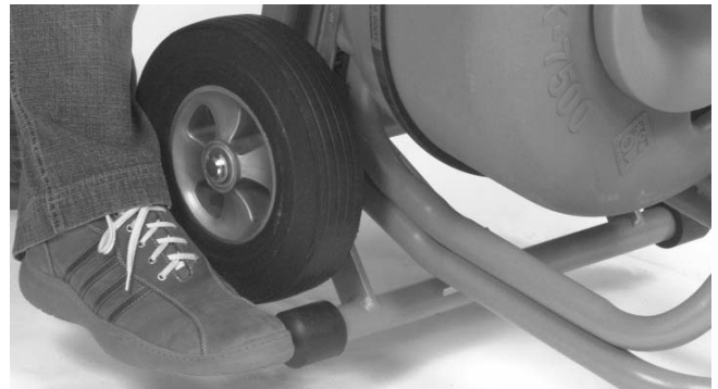
Figure 8 – Engagement de la béquille
