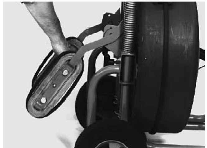
Figura 3 – Cómo levantar el trepaescaleras
